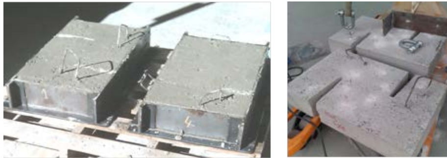
Figura 3.12: Probetas (c) tras hormigonar y (d) tras desmoldar.
