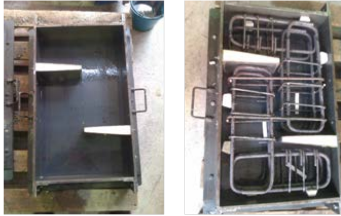
Figura 3.11: Molde (a) sin y (b) con armaduras antes de hormigonar.
