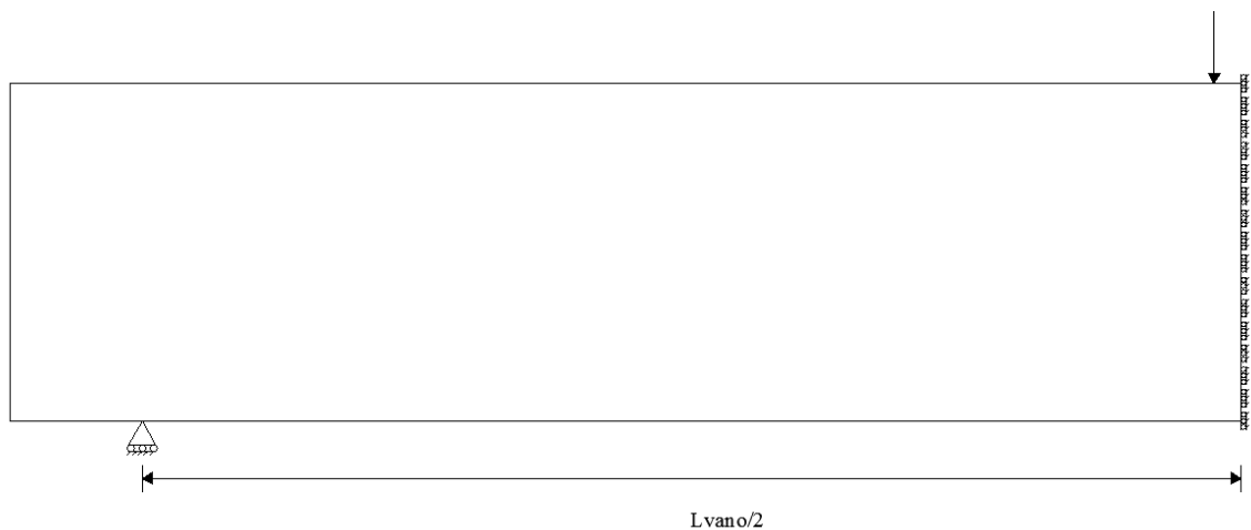
Figura E.2: Condiciones de contorno y de carga de la viga biapoyada en un corte por simetría.
