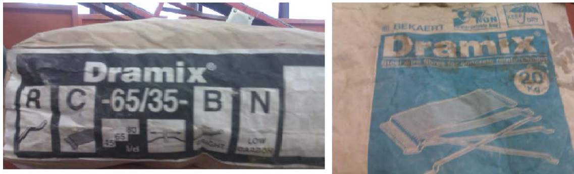
Figura 3.3: Fibras tipo "Dramix RC-65/35-BN"
